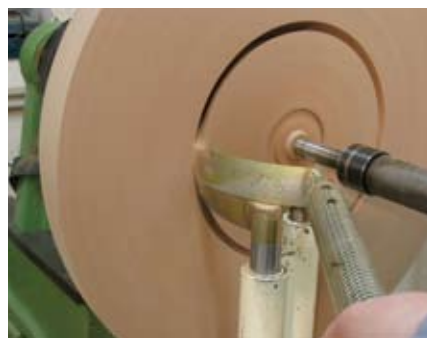
Dank der Führungsstütze ist ein ruhiges und sicheres Arbeiten der Schneide möglich.
