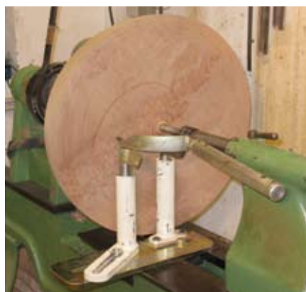
Das Coring System wird mit wenigen Handgriffen auf die Drehbank montiert und eingestellt.
