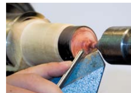
11 Die letzte Feinheit vor dem Schleifen bekommt die Oberfläche durch Abnahme eines feinen Spanes mit einer geschärften und frisch abgezogenen Röhre.
