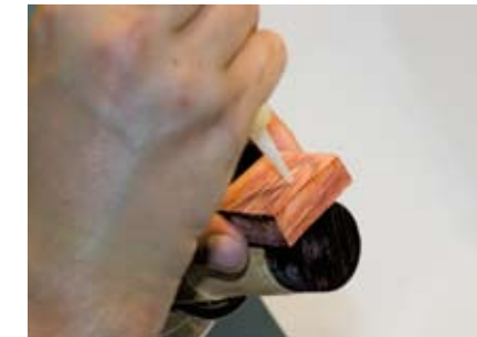
6 Nun wird das in diesem Fall obere Holzteil aus Rosenholz mit Sekundenkleber (z.B. mittlerer Viskosität) aufgeleimt. Dabei ist zu beachten, dass auch dieses Holzteil eine plan gehobelte bzw. geschliffene Fläche aufweist.
