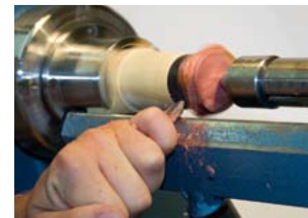
8 Dann wird nun auch das Rosenholzstück in runde Form gebracht, und mit dem Ebenholz überdreht.
