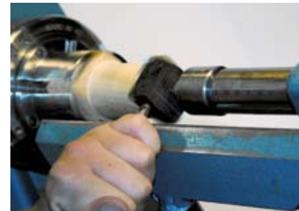
4 Nach dem Abkühlen des Heißklebers, kann das quadratische Stück in eine runde Form gebracht werden. Bedenken Sie: Wir arbeiten hier in Querholz, die Drechseltechnik gleicht der beim Drechseln von z.B. Schalen.
