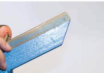
14 Die Oberfläche wird nun mit einem feinen Schleifstein feiner geschliffen. Bei sehr weichen Hölzern, kann hierbei bereits mit einem Schleifpapier begonnen werden.
