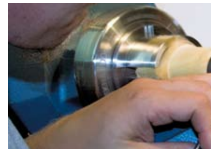
13 Der kleine Zapfen, der bis dahin für die Reitstockunterstützung benötigt wurde, wird nun entfernt. Anstatt des Zapfens wird eine ebene Fläche von ca. 8-10 mm als Auflagefläche für die spätere Achse angedreht.
