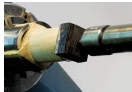
3 Zügig wird nun ein quadratisches Stück Makassar Ebenholz aufgeklebt. Die Faser verläuft hier quer zur Drehachse. Während des Auskühlens des Klebstoffes wird mit dem Reitstock zentriert und Druck aufgebaut.
