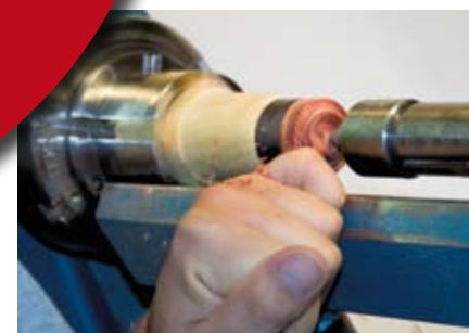
10 Der Kreiselkörper wird nun nach eigenem Geschmack in Querholztechnik gedreht. Hier eine flache konische Form.
