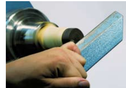
5 Auch die Stirnseite muss zu 100% plan gedreht werden, damit sie im rechten Winkel zur Drehachse steht. Eine Wölbung würde später einen sichtbaren Spalt (auch wenn dieser mit Klebstoff gefüllt ist) ergeben.
