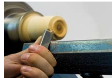
1 Im ersten Schritt wird ein Blindholz z.B. Linde oder ähnl. als Hilfsfutter vorbereitet und hierfür in einem Backenfutter (oder Spundfutter) rund gedreht. Die Stirnseite sollte sauber plan gestochen werden (mit Lineal prüfen).
