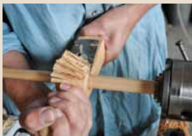
Rundstäbe gehobelt Anleitung von Jan Hovens ab Seite 8
